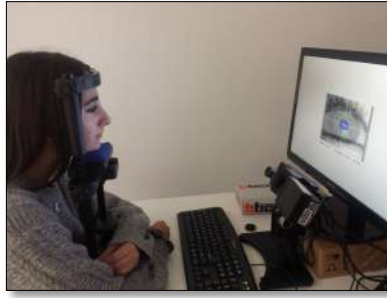
Figura 7.4: Representació del muntatge de l'eye tracker amb un subjecte mentre realitza la calibració
